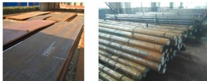
C级：氧化皮已因锈蚀而剥落或可以刮除，并有少量点蚀的钢材表面
