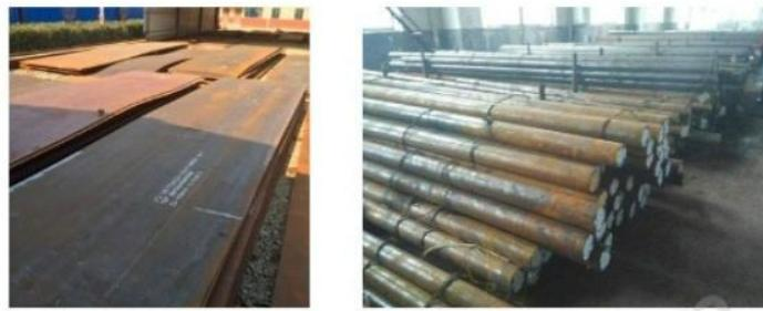
C级：氧化皮已因锈蚀而剥落或可以刮除，并有少量点蚀的钢材表面
