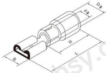
导线截面:4~6mm<sup>2</sup>(12~10) 最大电流:Imax=24A
